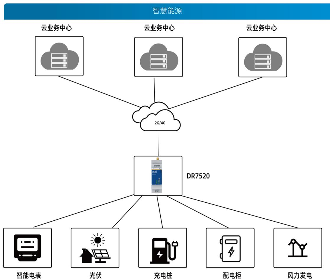
智慧能源解决方案中，借助DR7520体积小、可进行导轨安装的特点，可集中安装在低压配电柜中，节约空间，解决智慧能源系统中各种物联网数据的采集传输，实现配电数据的统一接入，智能采集控制和集中管理。
