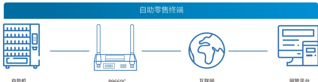
自助售货机、自助售票机等自助零售终端，大部分应用于商场以及地铁、火车站等位于负楼层的地点，联网布线难，成本过高。并往往面临着网络信号差、运行不稳定等问题。R9660C系列工业路由器很好的解决了这些问题，使用无线联网替代有线联网，节省建设成本。构建4G联网保证网络状况，并与自助机联网系统的管理中心服务器主机建立数据通道，实现自助机终端无线组网，实时上传零售数据。支持多种VPN加密模式，为自助机提供数据传输安全防护。
